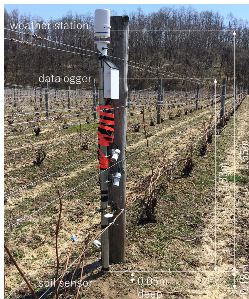
写真1. 気象観測用センサ類の設置風景。 Photo 1. Sensors for measuring weather parameters.
